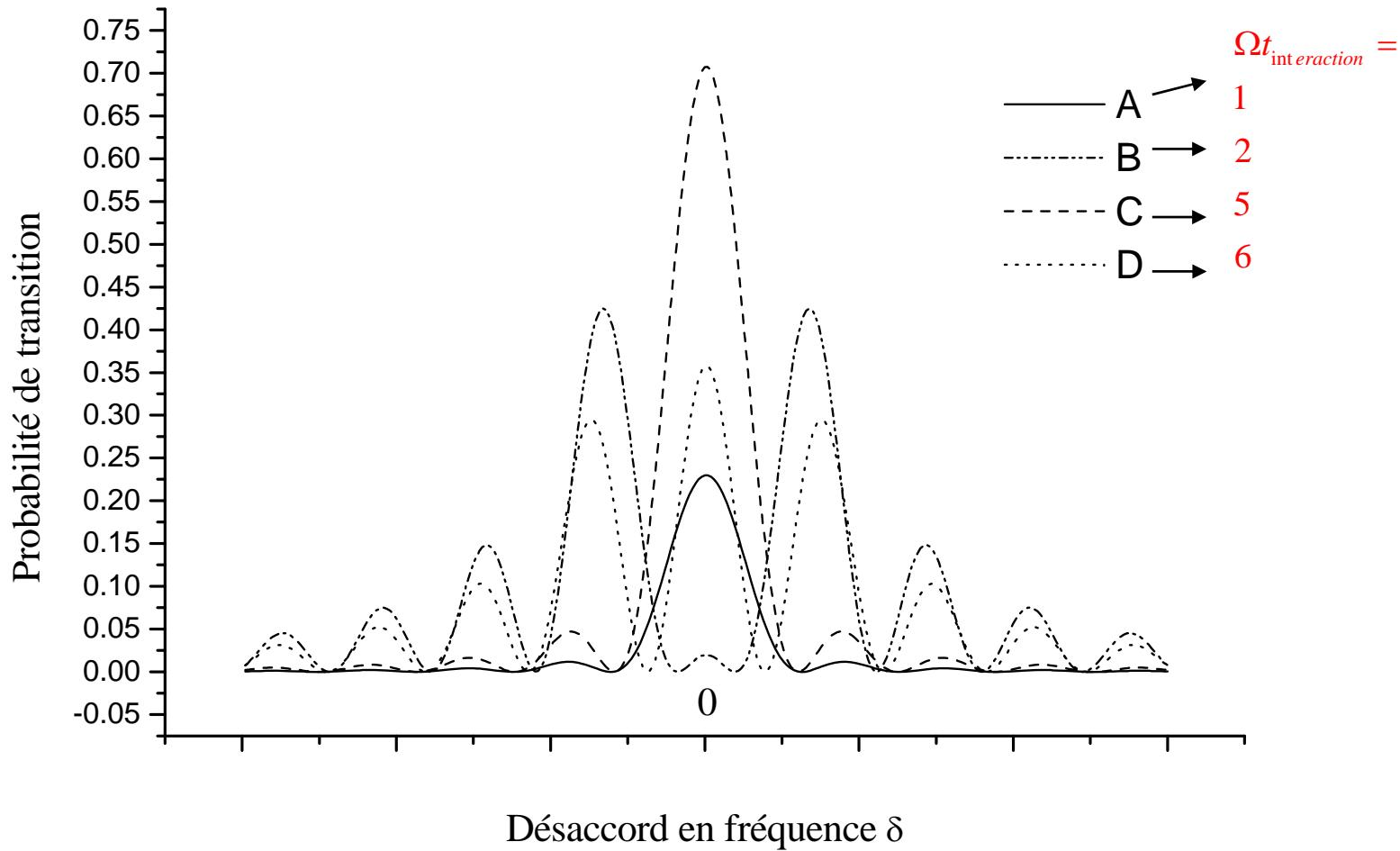
Profil de Rabi d'un jet ralenti à  $v=50\text{m/s}$  sur transition d'horloge à Cs
