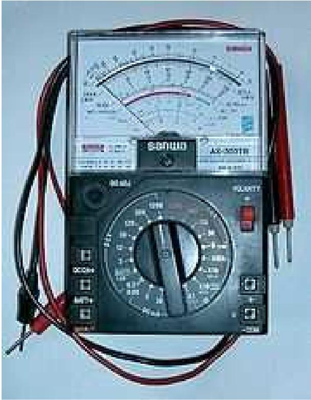
Un *multimetro* o *multitester*, e' uno strumento di misura elettrico che combina diverse funzioni. Un multimetro standard può misurare voltaggi, correnti e resistenze. Il multimetro analogico è dotato di un indicatore discosto dal piano della graduazione, cosicchè l'indice si vede
