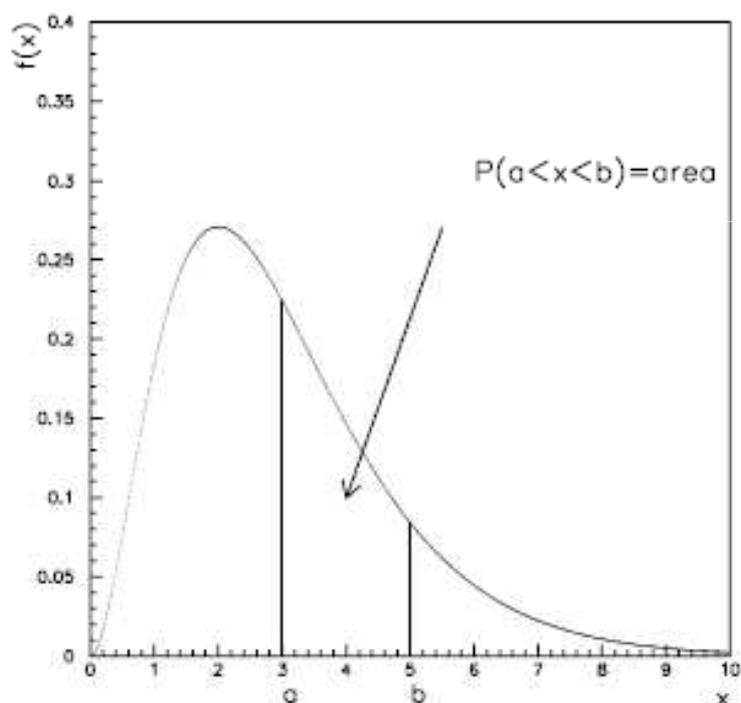
Fig.2.3 Esempio di densità di probabilità  $f(x)$  della variabile casuale continua  $x$  definita nell'intervallo  $(0,10)$ . L'area complessiva sottesa alla curva è pari a 1. Per determinare la probabilità che  $x$  sia compresa tra i 2 valori  $a$  e  $b$ , (pari rispettivamente a 3 e 5 in questo caso) si deve valutare l'area indicata.
