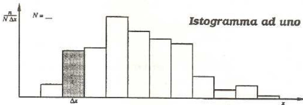
Figura 2.4: Esempio di istogramma normalizzato ad uno
