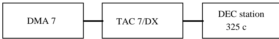
Figura 2: Schema a blocchi dell'analizzatore dinamico-meccanico.
