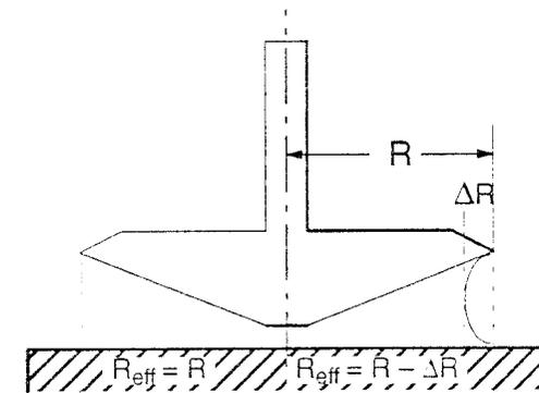
L'errore sulla misura della viscosità si può ricavare dalla seguente equazione:
