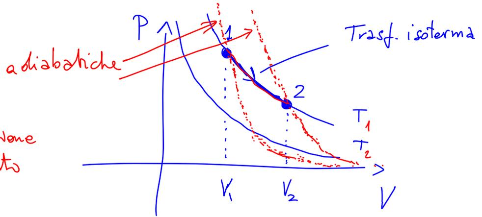
Calcolare  $\delta Q$  in una trasformazione isoterma sapendo che l'energia interna del gas perfetto dipende solo dalla temperatura
