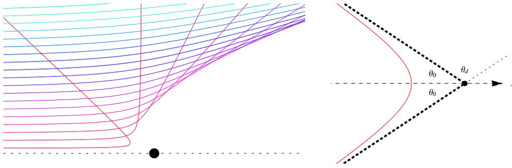
Figura 2.4: **Sinistra:** traiettorie per urti fra particelle  $\alpha$  su nucleo pesante con diversi parametri di impatto. **Destra:** geometria per il conto esplicito.
