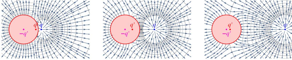
Figura 6.4: *Linee di campo e superfici equipotenziali in presenza di una carica  $q$  a distanze varie da una sfera conduttrice isolata.*
