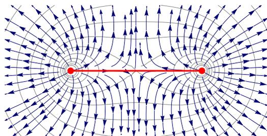
Figura 2.3: *Linee di campo elettrico e superfici equipotenziali nel piano  $xz$  generate da un anello circolare uniformemente carico nel piano  $xy$  (visto di taglio è la linea rossa nella figura).*
