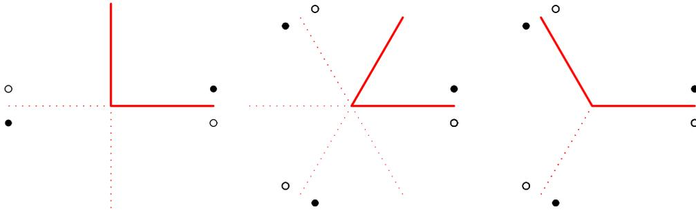
Figura 6.1: Il metodo delle immagini consente di risolvere problemi con due semi-piani conduttori che si intersecano con angoli di  $90^\circ$ ,  $60^\circ$ , ma non per  $120^\circ$ .
