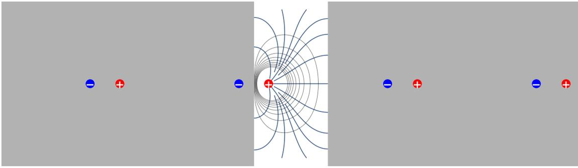
Figura 6.2: Carica fra due piani conduttori, sistema di cariche immagine, curve di livello del potenziale elettrico e linee di campo.
