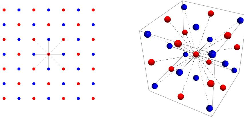
Figura 3.1: Reticolo  $\text{Na}^+\text{Cl}^-$ : sezione bidimensionale e cella tridimensionale.
