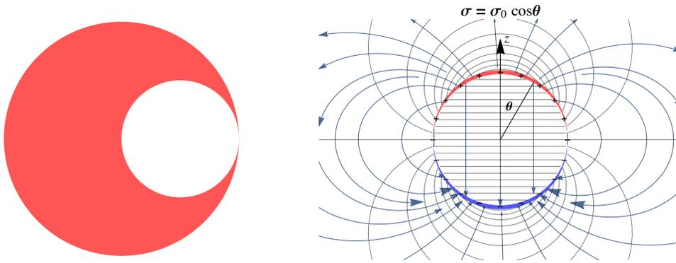
Figura 4.1: **Sinistra:** sfera bucata. **Destra:** sfera polarizzata. Linee di campo (curve con frecce) e superfici equipotenziali generate da una ‘sfera polarizzata’.
