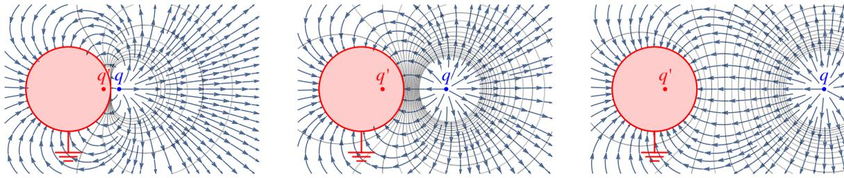
Figura 6.3: Linee di campo e superfici equipotenziali in presenza di una carica  $q$  a distanze varie da una sfera conduttrice a terra.
