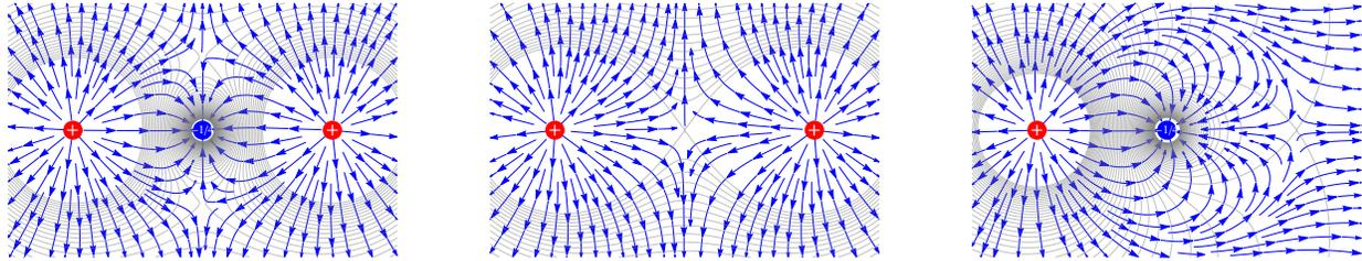
Figura 2.1: Tentativo di costruire un sistema stabile di 3 cariche. A sinistra le linee del campo totale in blu e le linee equipotenziali in grigio; nel centro quelle ottenute omettendo la carica di centro; a destra quelle ottenute omettendo la carica di destra.
