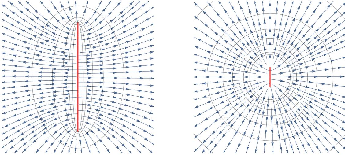
Figura 2.2: Linee di campo elettrico e superfici equipotenziali generate da un filo finito uniformemente carico di lunghezza  $l$ . A distanze molto maggiori di  $l$  si riduce ad una carica puntiforme.
