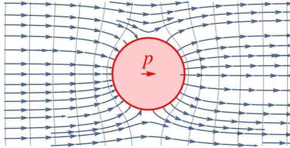
Figura 6.5: *Linee di campo e superfici equipotenziali in presenza di una sfera conduttrice isolata in un campo elettrico  $E$  esterno costante.*
