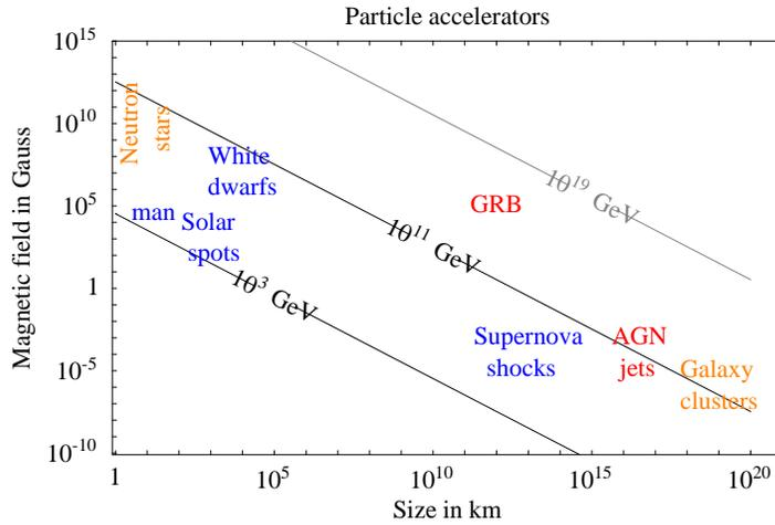
Figura 12.2: Massima energia raggiungibile da acceleratori di particelle in funzione della loro dimensione e del loro campo magnetico.
