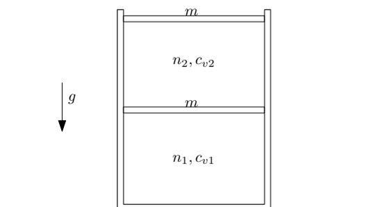
Il recipiente in figura di sezione  $S$  è diviso in due parti da due setti scorrevoli di massa  $m$ . I due volumi sono occupati da una mole di un gas perfetto monoatomico. Il setto superiore è impermeabile al calore, ed il sistema si trova inizialmente all'equilibrio (la pressione esterna è trascurabile) con entrambi i gas ad una temperatura  $T_0$ .
