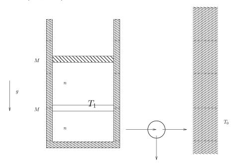
Il recipiente cilindrico in figura di sezione S è diviso in due scomparti da dei setti scorrevoli senza attrito di massa M. Il setto intermedio permette scambi di calore, mentre recipiente e setto superiore sono termicamente isolanti. Ciascuno scomparto contiene n moli di gas perfetto, ad una temperatura iniziale  $T_1$ . Si trascuri la pressione atmosferica esterna.
