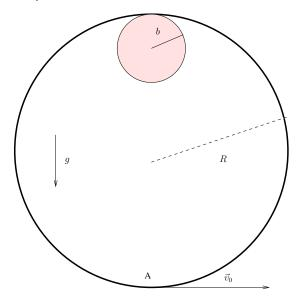
L'anello sottile in figura, di massa M e raggio R, può ruotare senza strisciare su un perno circolare di raggio b sul quale è appoggiato, ed inizialmente si trova con il centro di massa nella posizione più bassa possibile, mentre il suo estremo inferiore (indicato in figura con A) si muove con velocità  $v_0$  in modulo.
