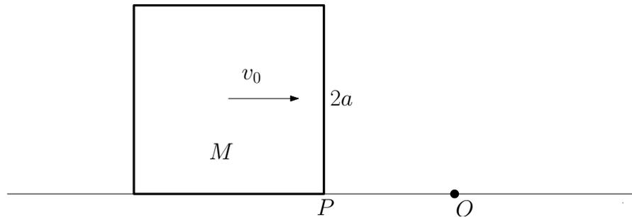
Il cubo in figura di lato  $2a$  e massa  $M$  si muove con velocità iniziale  $v_0$  su un piano privo di attrito. Può ruotare liberamente attorno al suo spigolo  $P$ , ma quest'ultimo non può staccarsi dal piano orizzontale. Nel punto  $O$  si trova un ostacolo che impedisce il passaggio di  $P$ .
