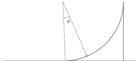
Detta  $X$  la posizione orizzontale del centro dell'arco di circonferenza, e  $\theta$  l'angolo che determina la posizione della pallina su di esso come in figura, possiamo scrivere la quantità di moto orizzontale come
