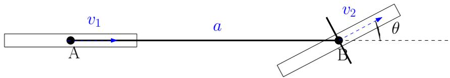
Una schema molto semplice di bicicletta è rappresentato in figura. I due punti di contatto con il suolo  $A$  e  $B$  si muovono istante per istante con velocità  $\vec{v}_1$  e  $\vec{v}_2$ , parallelamente alla direzione della ruota. Poniamo  $a = \overline{AB}$  e indichiamo con  $\theta$  l'angolo di rotazione del manubrio.
