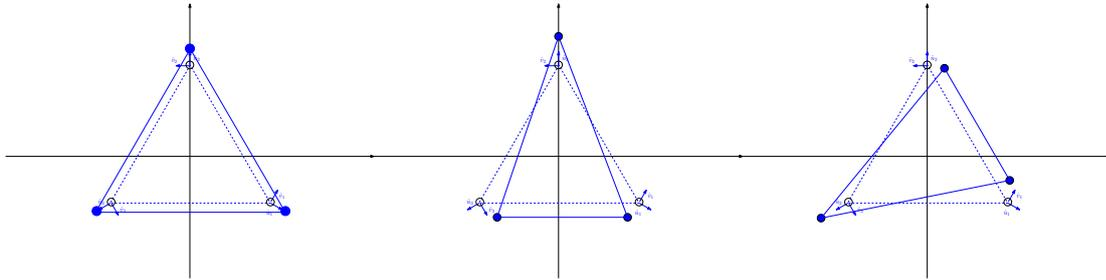
Figura 5.122.: I modi di oscillazione corrispondenti ai vettori  $\mathbf{Q}_4$ ,  $\mathbf{Q}_5$  e  $\mathbf{Q}_6$ . Il modo  $\mathbf{Q}_6$  si ottiene dal  $\mathbf{Q}_5$  con una rotazione antioraria di  $2\pi/3$ .
