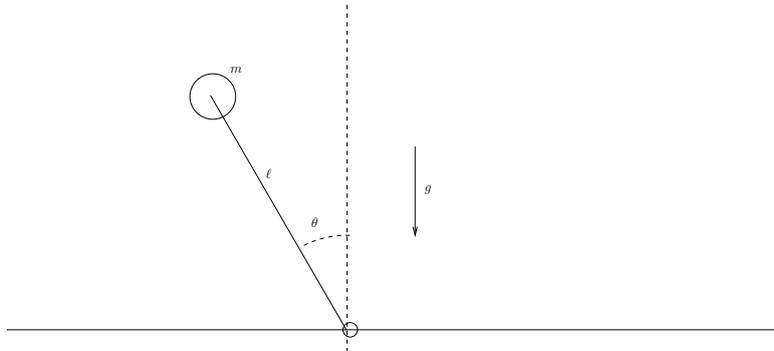
Figura 5.62.: Rappresentazione schematica di un pendolo invertito.
