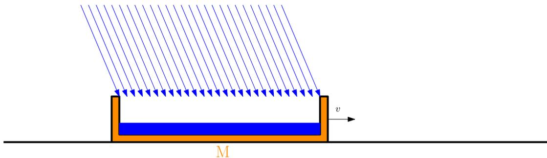
Figura 5.74.: La scodella ha una sezione orizzontale  $S$ , la pioggia cade su di essa con un angolo determinato dalle componenti orizzontali e verticali della velocità. Se la scodella è ferma, la massa di acqua raccolta in un'unità di tempo è costante e vale  $\Gamma$ .
