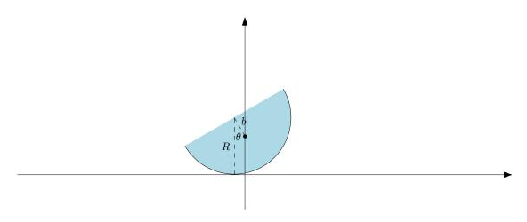
Figura 6.23.: Il semicilindro durante l'oscillazione, in un sistema di riferimento nel quale la componente orizzontale della velocità del centro di massa è nulla. Il sistema è stato scelto in modo che il centro di massa (indicato dal punto scuro) si trovi sull'asse delle ordinate.
