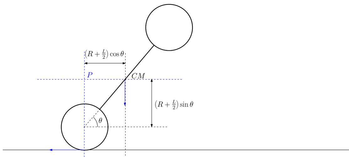
Figura 6.30.: Il manubrio ruota attorno al punto fisso  $P$ , che si può determinare con la costruzione in figura notando che il punto di contatto col terreno si muove orizzontalmente e il centro di massa verticalmente. Quindi  $P$  deve trovarsi alle intersezioni delle rette perpendicolari alle due velocità.
