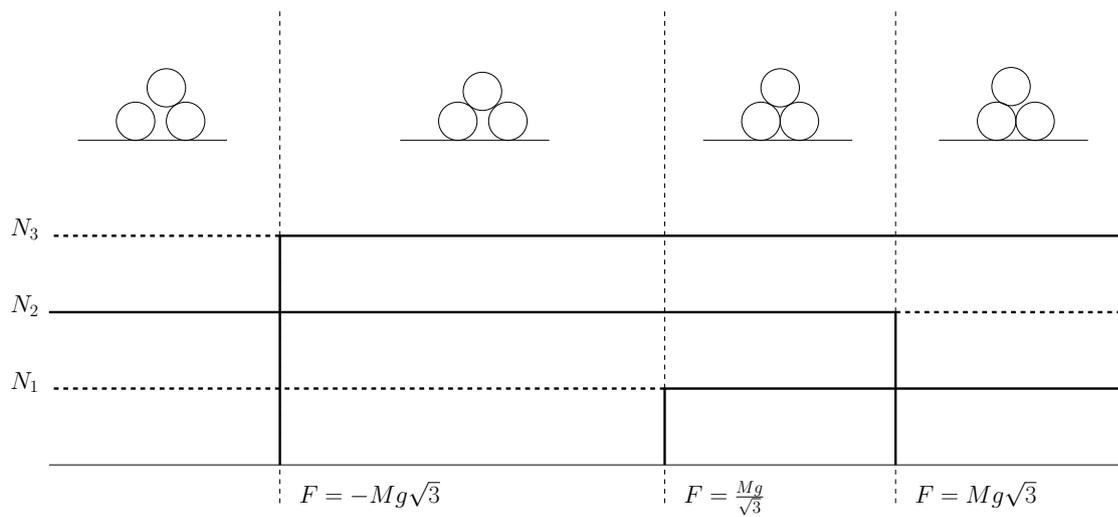
Figura 6.58.: Il segno delle reazioni normali al variare di  $F$ . Le posizioni relative rimangono invariate solo nell'intervallo  $Mg/\sqrt{3} < F < Mg\sqrt{3}$ . In tutti gli altri casi almeno una delle reazioni  $N_i$  diviene negativa, segnalando che i cilindri perdono contatto nel modo indicato.
