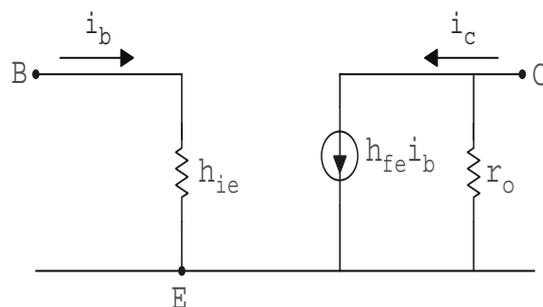
**Figura 6.11:** Modello a parametri  $h$  del transistor bipolare. Sono presenti i parametri  $h_{ie}$ ,  $h_{oe}=1/r_o$  ed  $h_{fe}$
