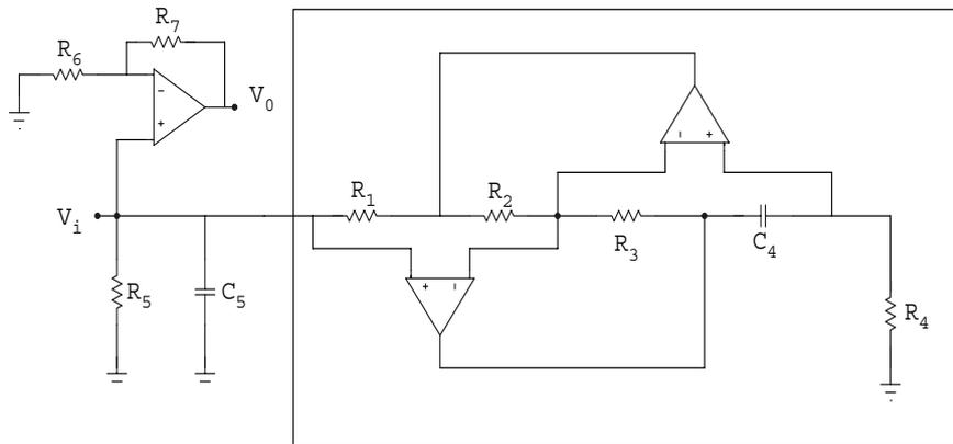
**Figura 14.14:** Filtro passa-basso di ordine 2 ottenuto sostituendo l'induttanza con un giratore di Antoniou. L'utilizzo delle induttanze è sconsigliato nella pratica, a causa del costo e dell'ingombro elevato. L'utilizzo di questo circuito permette di ottenere la stessa risposta di un filtro RLC utilizzando solamente componenti di tipo R e C oltre ad i componenti attivi.
