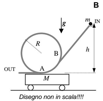
a. Quanto vale in modulo la velocità  $V_A$  del **carrellino** nell’istante in cui la pallina passa per il punto più basso del giro della morte (marcato con A in figura)? [Per il segno, usate il riferimento indicato in figura; inoltre spiegate **per bene** in brutta ogni passaggio della soluzione!]
