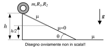
a) Discutete per bene, in brutta, che tipo di moto compie il cilindro cavo nel **primo** tratto del piano inclinato, quello **scabro**, e spiegate il perché; inoltre calcolate il modulo dell'accelerazione del centro di massa  $a_{CM}$  in tale tratto.
