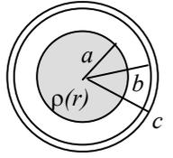
d) Immaginate ora che una sfera analoga a quella considerata sia racchiusa dentro un guscio **conduttore** sferico, concentrico alla sfera e dotato di raggio interno  $b$  e raggio esterno  $c$  come rappresentato in figura. Come si scrivono le cariche  $Q_b$  e  $Q_c$  che **all'equilibrio** si trovano sulle superfici interna ( $R=b$ ) ed esterna ( $R=c$ ) del guscio? [considerate inizialmente **scarico** il guscio conduttore]
