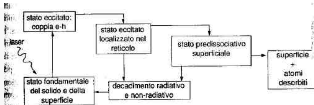
Fig. 2.4. Schema dei processi di interazione laser-materia che conducono alla liberazione di materiale dalla superficie di un target dielettrico (adattata da [37]).
