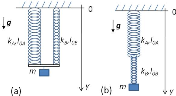
FIG. 3. Rappresentazione dei sistemi di molle in parallelo (a) e in serie (b) discussi nel testo. I disegni vanno ovviamente intesi come schematici e non in scala.
