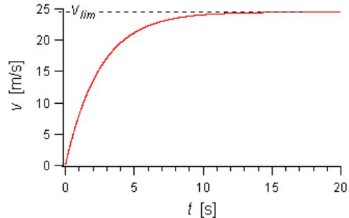
FIG. 2. Andamento della funzione  $v(t)$  calcolata supponendo  $m = 50$  kg e  $\beta = 5.0$  kg/s; nel calcolo si è supposto  $t_0 = 0$  e  $v_0 = 0$ , secondo quanto discusso nel testo.
