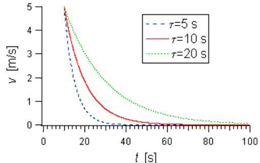
FIG. 1. Andamento della funzione  $v(t)$  calcolata per  $v_0 = 5.0$  m/s e per vari valori di  $\tau$ , come indicato in legenda; nel grafico si è supposto  $t_0 = 10$  s.
