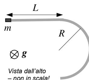
a. Quanto vale il valore **massimo**  $a_M$  che l'accelerazione può assumere affinché il punto materiale (l'automobile) possa percorrere la curva "senza sbandare"? [Usate il valore  $g = 9.8 \text{ m/s}^2$  per il modulo dell'accelerazione di gravità]
