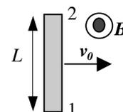
a. Quanto vale, in condizioni di equilibrio, la differenza di potenziale  $V_{12}$  tra le due superfici di base della bacchetta? [A scanso di equivoci, la figura riporta le indicazioni 1 e 2 corrispondenti alle due superfici; per determinare il segno, si intenda  $V_{12} = \phi_1 - \phi_2$ ]
