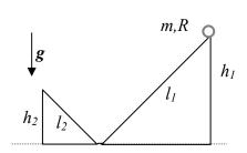
a. Ad un dato istante il guscio cilindrico viene lasciato libero di scendere lungo il primo piano inclinato e risalire sul secondo fino a lasciarlo, e si osserva che il suo moto è di **rotolamento puro**: quanto deve valere, **al minimo**, il coefficiente di attrito μ tra superficie del percorso e guscio cilindrico affinché questo sia possibile? [Stabilite voi se si tratta di attrito statico o dinamico!]
