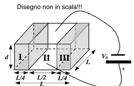
una regione di larghezza  $L/2$  (simmetrica rispetto alla mezzeria del sistema). La presenza dei due elementi di materiale debolmente conduttore determina quindi una suddivisione in tre regioni dello spazio fra le armature: le regioni I e III (vedi figura) sono piene di materiale, la regione II è vuota. Il condensatore è collegato a un generatore ideale di differenza di potenziale  $V_0 = 1.0 \times 10^2$  V come mostrato in figura.
