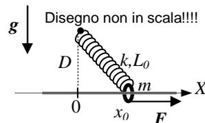
a) Inizialmente l'anello è sottoposto a una forza esterna di modulo  $F$ , direzione orizzontale e verso come in figura, che mantiene l'anello in equilibrio nella posizione  $x_0 = L_0 = 1.0$  m. Quanto vale il modulo della forza  $F$ ?
