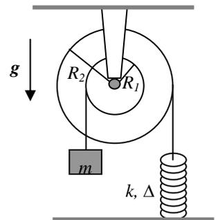
a) Sapendo che il disco di raggio  $R_1$  ha momento di inerzia  $I_1$  e supponendo che i dischi siano **omogenei** e fatti **dello stesso materiale**, quanto vale  $I_2$ ? [Considerate momenti di inerzia per rotazioni rispetto all'asse dei dischi, ricordate che, dal testo del problema,  $R_2 = 2R_1$ , e notate che la densità di massa è la stessa nei due casi]
