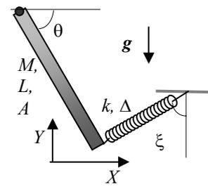
$\Delta = \dots\dots\dots = \dots\dots\dots$  m       $Mg x_{CM} \cos\theta / (kL) = 3Mg \cos\theta / (4k) = 2.45$  m [viene dall'equilibrio dei momenti delle forze rispetto al perno di rotazione, notando che le forze che danno un momento non nullo sono la forza peso  $Mg$ , applicata al baricentro e quindi con un braccio  $x_{CM} \cos\theta$  rispetto al perno, e la forza elastica, di modulo  $k\Delta$  e braccio  $L$ , essendo diretta ortogonalmente all'asta]
