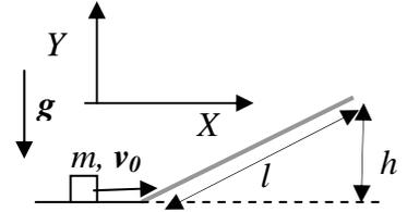
a) Quando la massa si trova sul piano inclinato, quanto valgono le componenti  $N_X$  ed  $N_Y$  della reazione vincolare espresse **nel sistema di riferimento indicato in figura?**
