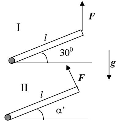
a) Nelle condizioni di figura I, il cilindro è vuoto e il sistema è in equilibrio: se l'asse del cilindro forma un angolo  $\alpha = 30^\circ$  con l'orizzontale, quanto vale la forza  $F$  esercitata dal dinamometro?
