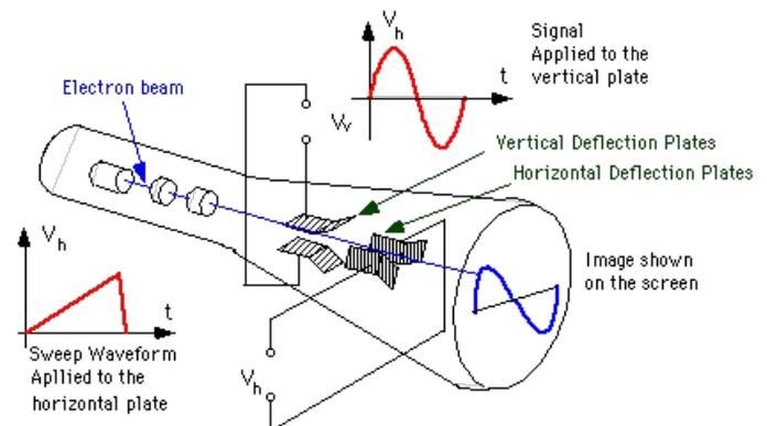
Figura 1. Schema di massima del tubo catodico.
