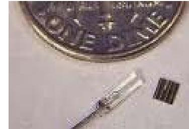
**Diapason fatto di quarzo sintetico** ( $\text{SiO}_x$ ) dotato di elettrodi metallici collegati a due filini
