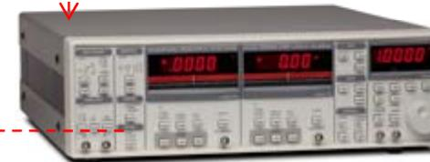
Lock-in: serve per **misurare** l'ampiezza di oscillazione (segnale elettrico proporzionale all'ampiezza di oscillazione meccanica)
