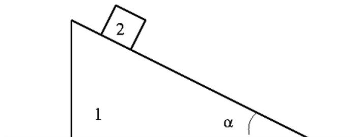
**Il corpo 2 è libero di scorrere sul piano inclinato 1. Il corpo 1 può muoversi orizzontalmente sul piano di appoggio. Note le masse dei due corpi e l'angolo determinare il moto dei due corpi e la traiettoria seguita dal corpo 2.**
