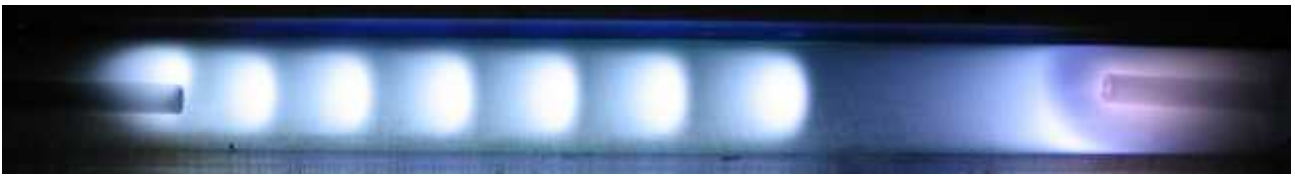
Figura 6 Una tipica immagine di “striations” in un tubo di scarica (da: http://www.sparkbangbuzz.com/crt/crt6.htm )
