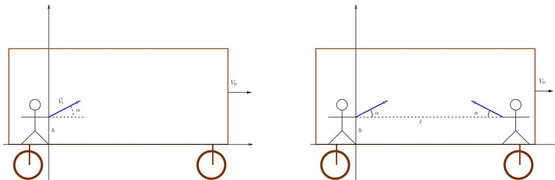
All'interno di un vagone ferroviario che si muove con velocità costante  $V_{tr}$  viene lanciato un oggetto la cui velocità iniziale relativa al vagone forma un angolo  $\alpha$  rispetto all'orizzontale ed ha modulo  $V_r$ . Al momento del lancio l'oggetto si trova ad una altezza  $h$  rispetto al pavimento del vagone (in figura, a sinistra).
