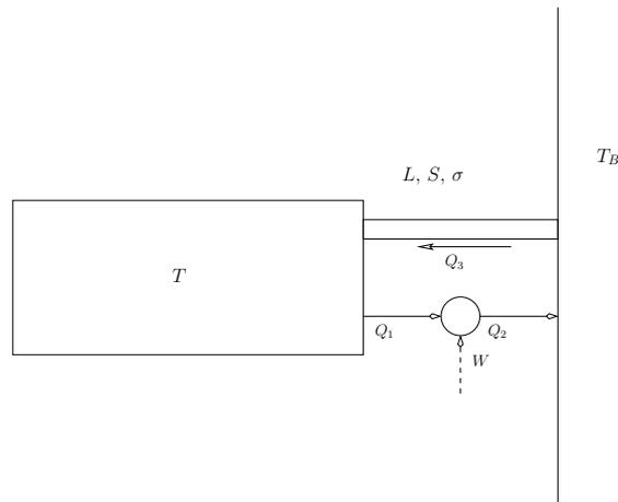
Un corpo di capacità termica costante è posto in contatto termico con un bagno termico di temperatura  $T_B$  mediante una sbarra di lunghezza  $L$ , sezione  $S$  e conducibilità termica  $\sigma$ . Si vuole mantenere la sua temperatura ad un valore  $T = T_B/2$  estraendo calore mediante una macchina termica reversibile, come in figura.
