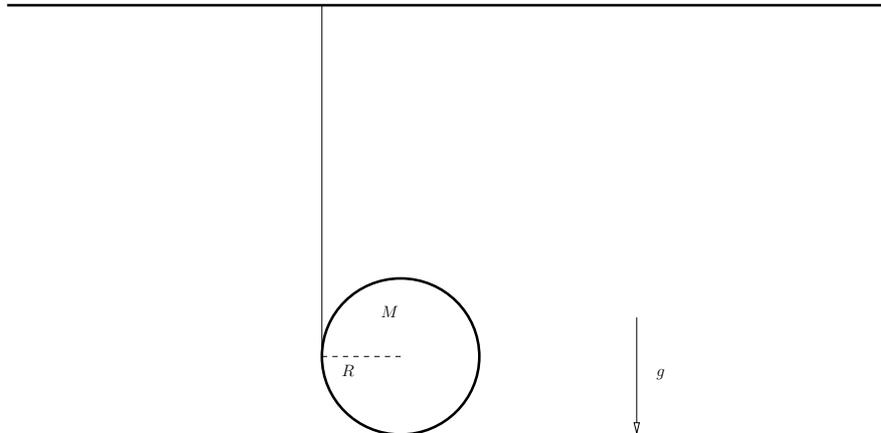
Il disco in figura, inizialmente in quiete, ha raggio  $R$  e massa  $M$ . Attorno ad esso è avvolto un filo inestensibile con densità lineare di massa  $\lambda$ . La lunghezza della parte avvolta è  $\ell$ , ed il filo è diretto verticalmente.
