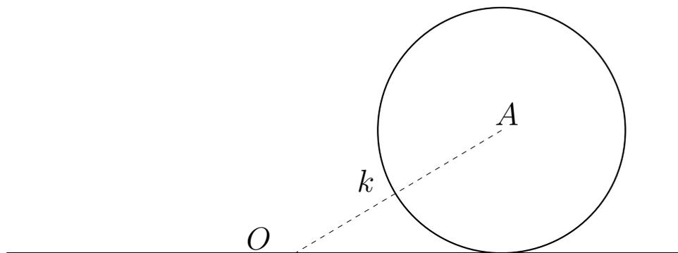
Il cilindro in figura, di raggio  $R$  e massa  $M$ , rotola senza strisciare su un piano orizzontale. Il suo centro  $A$  è fissato ad un punto  $O$  del piano da una molla di costante elastica  $k$  e lunghezza a riposo nulla. Inizialmente  $A$  si trova sulla verticale di  $O$ .
