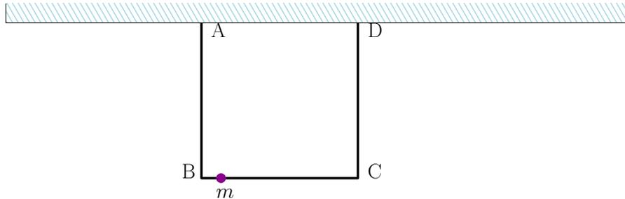
La struttura in figura è composta da tre aste identiche di lunghezza  $\ell$  e massa  $M$ . L'angolo delle giunzioni  $A$ ,  $B$ ,  $C$  e  $D$  è libero di variare, ed  $\overline{AD} = \ell$ . Inoltre una massa puntiforme  $m$  è fissata sulla barra  $BC$  ad una distanza  $x$  da  $B$ .
