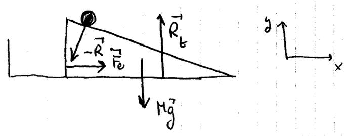
$$\begin{cases} M \ddot{X} = -R \sin d + F_e \\ M \ddot{y} = -R \cos d - Mg + R_t \end{cases} \quad F_e = -k(l-b) = k l_0 (1-\alpha)$$
