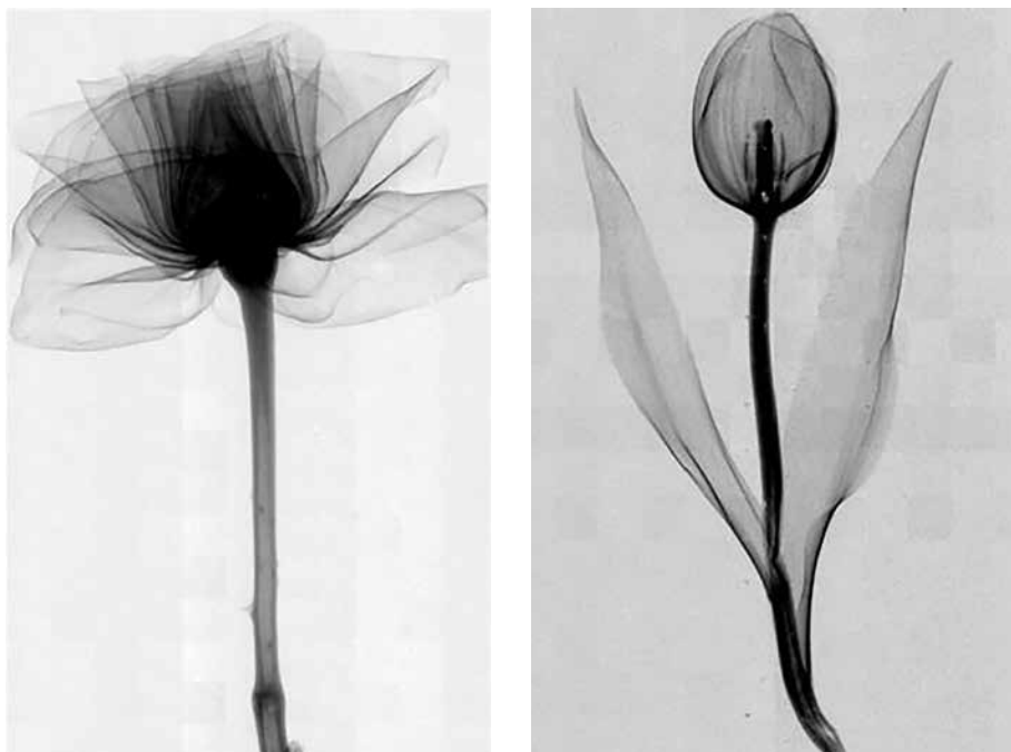
Figura 10. Immagini radiografiche di fiori ottenute con il rivelatore a pixel di GaAs ed uno tubo mammografico convenzionale.
