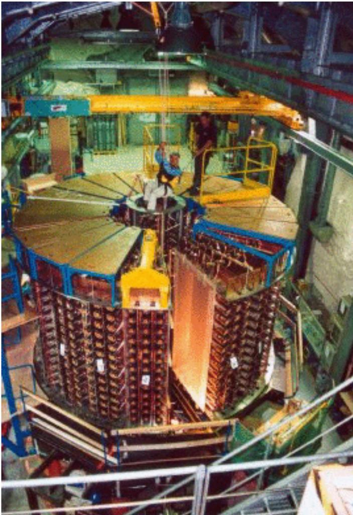
Rivelatore cilindrico in campo magnetico solenoidale  $B = 25$  Gauss diretto lungo la verticale
